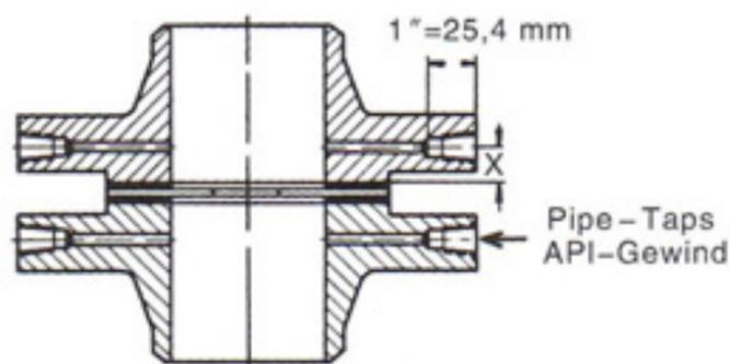
Meßscheibenflansche sind genormt in ASME/ANSI B 16.36. Sie entsprechen in weiten Teilen (Dichtflächenbearbeitung, Markierung usw.) den Regelungen der ASME/ANSI B 16.5.
